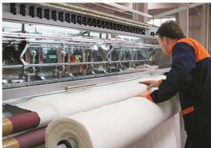
Stopping automatically when top cord ends or breaks Üst ip kopma ve bitmede otomatik durma
