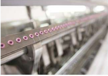
Top Thread Break Sensor; Machine stops automatically when thread breaks or ends, and gives an error message on screen. Üst ip koptu Sensörü; İp kopması, bitmesi halinde Makine otomatik olarak durmakta ve ekranda hata uyarısı vermektedir.
