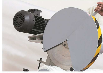
Rolling knife system with motors Motorlu döner bıçak sistemi
