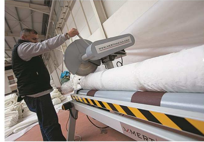
Rolling knife system with motors Motorlu döner bıçak sistemi
