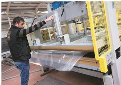
Semi-automatic mattress roll packing line Yarı otomatik rulo yatak paketleme hattı
