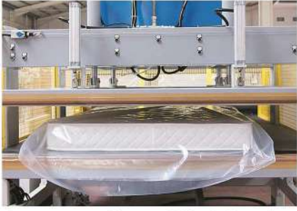
Flat mattress packing possibility for bonnell spring mattress Bonel yaylı yataklar için düz presleme imkanı
