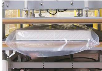
Mattress to be inserted into a preformed bag Yatak perforeli plastik içine konularak paketlenme
