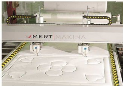
The machine is able to quilt materials from same stitch after provisional closure Makine kapatılığında kaldığı yerden dikiş imkanı
