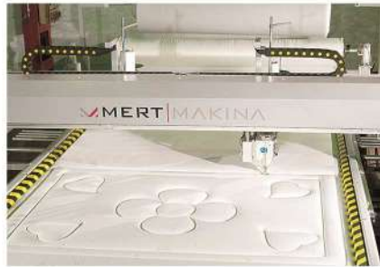
The machine is able to quilt materials from same stitch after provisional closure Makine kapatılığında kaldığı yerden dişik imkanı
