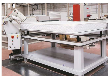
Adjustable position of the operator carriage around the table for small mattress Küçük yataklar için tablanın etrafındaki pozisyonu ayarlanabilir operatör taşıyıcı
