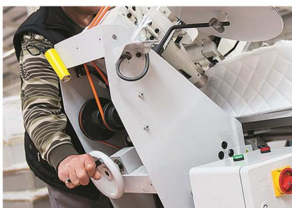
Head lifting range Dikiş kafası kaldırma kolu Manual adjusting table height and sewing head angle Manuel olarak masa yüksekliği ve kafa çapı ayarlama
